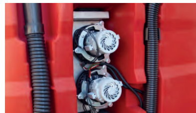
دارای دو موتور وکیوم و سیستم مکش سه مرحله ای برای مکش قدرتمند و خشک کنندگی بالا
