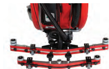
جایگزینی تی در عرض های متفاوت
