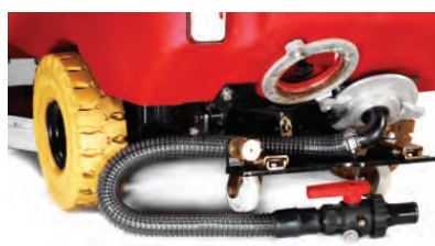
تخلیه آسان مخزن آب کثیف توسط شلنگ تخلیه
