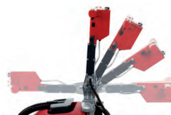
دسته متحرک امکان استفاده دستگاه در فضاهای کوچک یا کم ارتفاع را فراهم می سازد.
