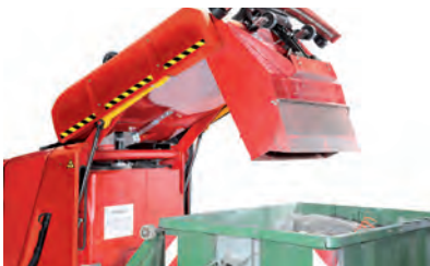
تخلیه زباله به صورت هیدرولیک
