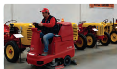
کاهش اتوماتیک سرعت هنگام دور زدن
