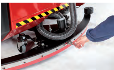
تعویض سریع لبه های لاستیک تی
