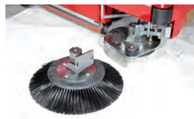
تعویض سریع برس جارویی با برس شوینده
