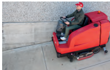
ترکشن روی چرخ های عقب جهت حرکت دستگاه در سطوح شیب دار و خیس
