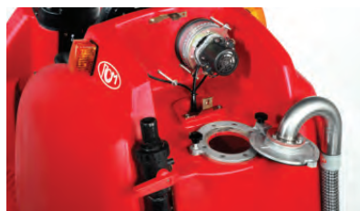
موتور وکیوم قوی با سیستم محافظت از کف و زباله
