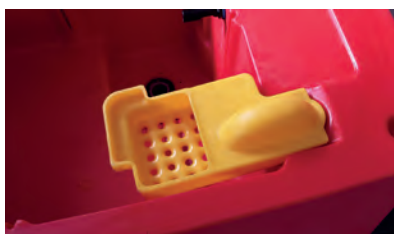
سبد مخصوص جهت فیلتر و جلوگیری از ورود آشغال به موتور و کیوم
