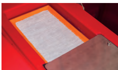
دارای فیلتر پلی استر به منظور محافظت موتور وکیوم از گرد و غبار
