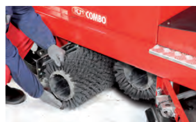
تعویض سریع برس های اصلی بدون نیاز به ابزار
