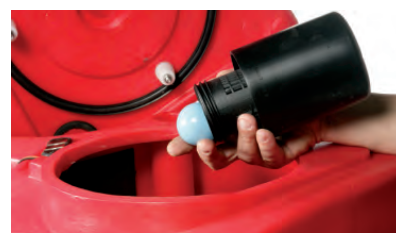
موتور وکیوم در سه مرحله از آب با یک شناور، از زباله با یک فیلتر و از کف با یک مخزن پلاستیکی برای طول عمر بیشتر محافظت می شود.
