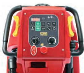
امکان کنترل سرعت توسط پدال دستی برای راندن دقیق و ایمن تر دستگاه
